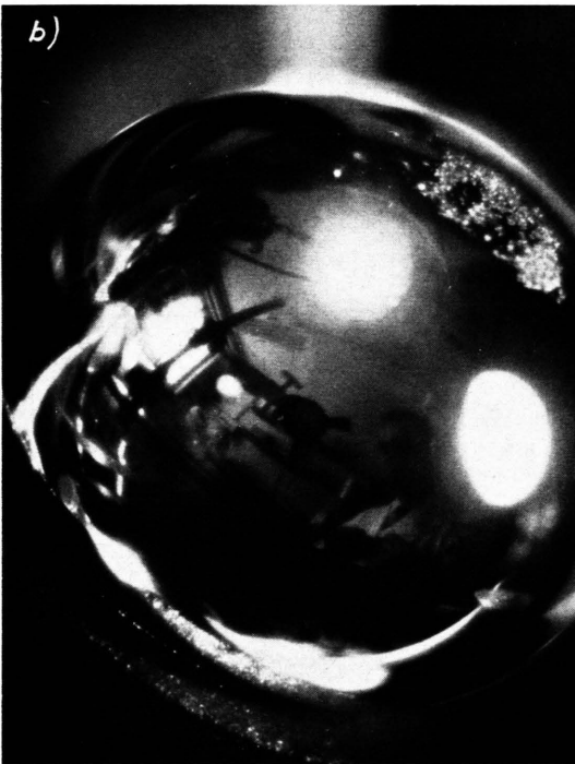
Abb. 1. Zur Präparation der Cu-Einkristallkugel. Vorrichtung zur Kristallzüchtung auf dem Präparathalter (a) ; Einkristallkugel (b).
